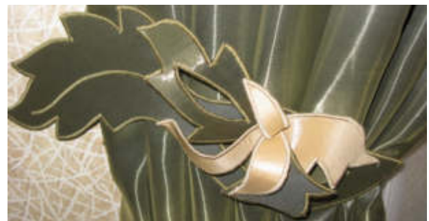
Рис. 4. Зовнішній вид: а – ажурного ламбрекена на етапі лазерного вирізання візерунку; б – підхвата штори із обметаними зигзаг стібком зрізами
