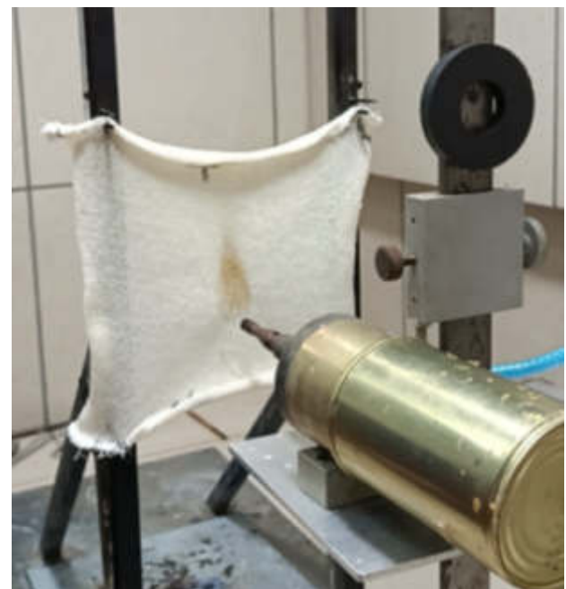
Рис. 1. Зображення лабораторної установки, що складається з рамки із закріпленою пробєю текстильного матеріалу, пальника та газового балона
