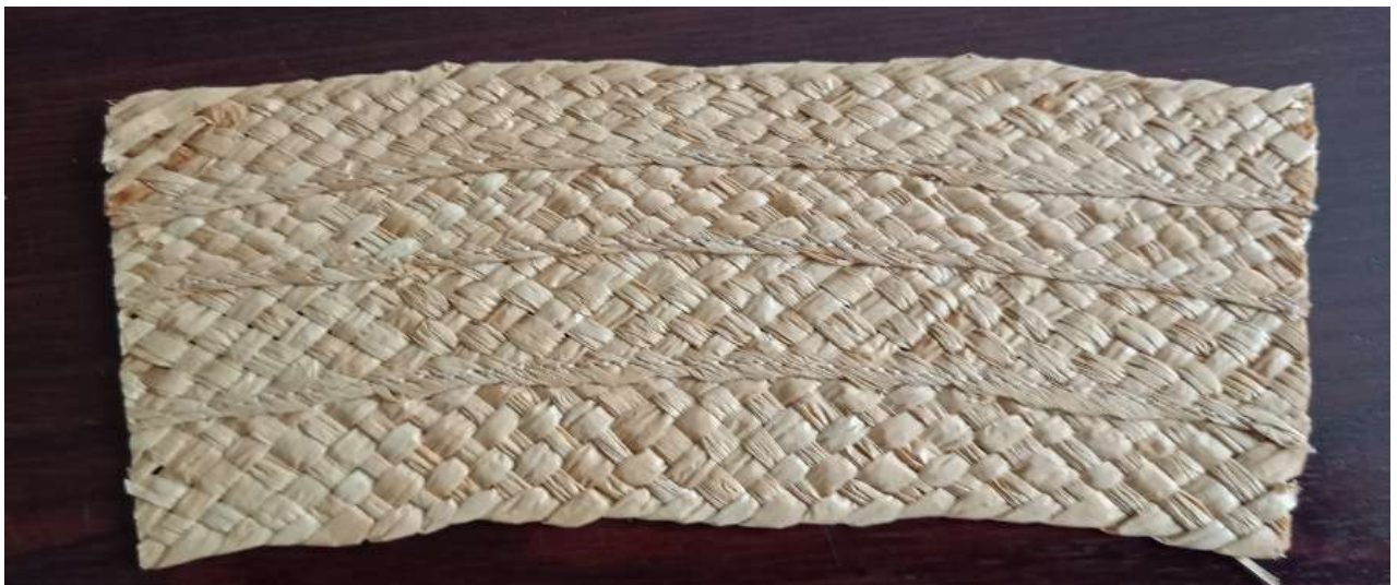
Рис. 4. Зовнішній вигляд напівфабрикату тулії та денця кашкету жіночого
